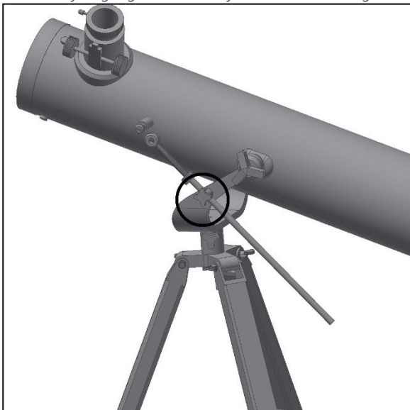
Abb. 6. Einführen der Stange zur Feineinstellung.
