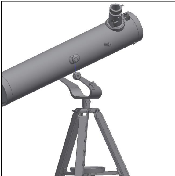
Abb. 4. Befestigung des Rohrs auf der Gabelhalterung.
