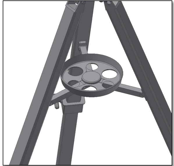
Abb. 3. Einbau der Ablage.
